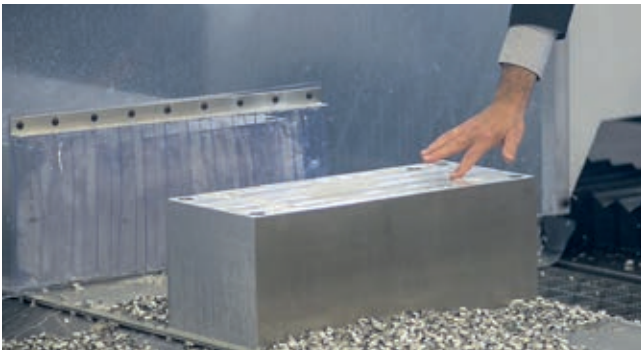
Die RigiMill übernimmt nicht nur die grobe Vorabarbeitung (Schruppen) sondern auch die spätere Feinbearbeitung (Schlichten).
