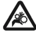
Peligro de arrastre
