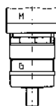
V1 - verticale arbre de sortie vers le bas V1 - Montaggio verticale albero d'uscita verso il basso
