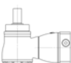
Montageposition V3/B5 (utgående axel uppåt, motoraxel horisontell)
