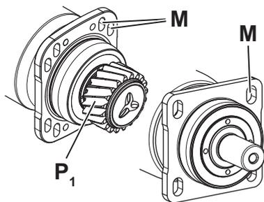
Le réducteur peut être équipé en option d'un pignon d'entraînement [P<sub>1</sub>]. Le jeu entre dents du pignon d'entraînement et de la crémaillère / roue conjuguée peut être réglé en utilisant les trous oblongs [M] et les rainures de guidage latérales. Aucun dispositif de réglage supplémentaire n'est nécessaire.
