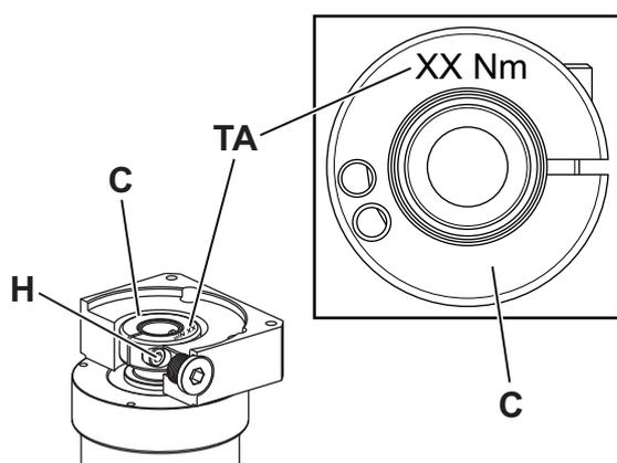
La valeur du couple de serrage [TA] de la vis de serrage [H] se trouve sur le moyeu de serrage [C].
