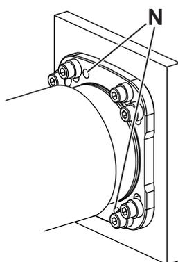
Deux perçages [N] en option sur le carter servent à goupiller le réducteur sur la machine. Il est également possible de fixer le réducteur sur la machine avec des goupilles cylindriques.
