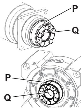
La fixation axiale de l'alésage non débouchant / arbre creux / interface d'arbre creux [Q] sur l'arbre de charge est réalisée à l'aide d'une frette de serrage. Si vous avez commandé un réducteur avec une frette de serrage [P], elle est déjà mise en place à la livraison.
