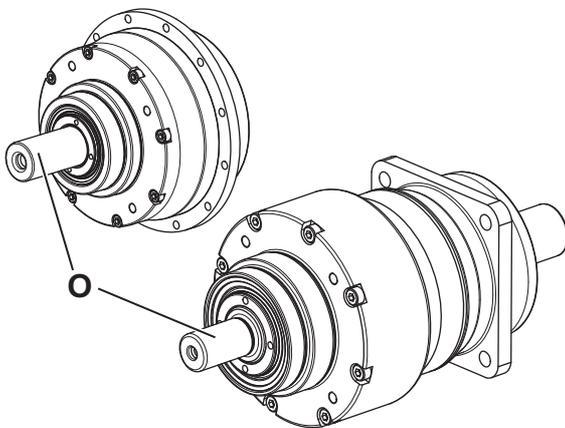
❗ **Seule** la variante de réducteur « version séparée » avec arbre d'entraînement [O] ne prévoit **aucun** assemblage moteur. L'arbre d'entraînement permet d'entraîner directement le réducteur, par exemple via une poulie pour courroie.
