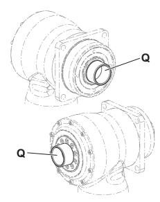
El anillo de contracción sirve para fijar un reductor con eje de inserción / eje hueco / interfaz de eje hueco [Q] a un eje de carga.
