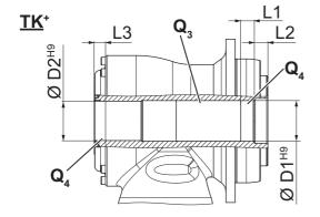
En el eje hueco / interfaz de eje hueco, las piezas vulnerables [Q<sub>3</sub>] deben protegerse contra medios agresivos.
