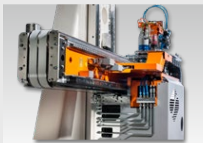
Transfert de presses Source : Strothmann Machines & Handling GmbH
