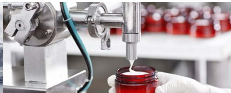
Cosmétique – Installation de remplissage pour crèmes
