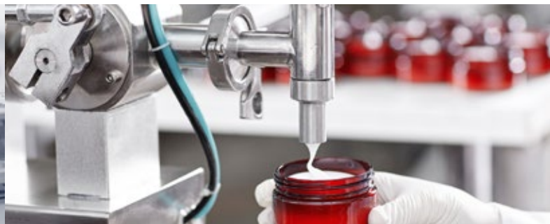
Cosmétique – Installation de remplissage pour crèmes
